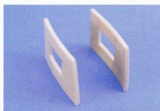
36: 曲面処理をした胴体側面パーツ 温度が下がりレジン板が固くなったら曲面加工の出来上がりです。台を使うことで左右を同じ曲率に曲げることができます。
