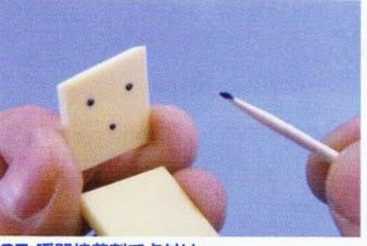
25: 瞬間接着剤で点付け 工程24で切り出した板を、直角にカットしたもう一枚の板に 瞬間接着剤(以下「瞬着」)で点付けします。接着にはウェーブの「黒い瞬間接着剤」を使っています。点付けに使うと透明なものに比べ接着剤が見えやすいので、後で削り落とす時に便利です。
