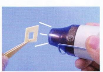
33: 胴体の側面の板をヒーターで加熱 胴体の側面の板をヒーターで加熱します。竹製のビンセット を使うと、柔らかくなった板に傷を付けずに保持することができます。
