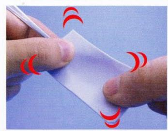
37: 三次曲面 (スプーン) 以前プラ板をクサビ状に切り込み加工をして、スプーンを例 に三次曲面の板を作りましたが、レジン板を使うともっと簡単 に三次曲面を作ることが可能です。写真は1.2ミリのレジン板
