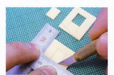
28: 胴体側面の穴開け 胴体側面の板は1.7ミリ厚に作ったものを使用しました。写真 は肩関節の穴を切り出しています。プラ板に比べるとサクサク とした感じでやや柔らかく、ナイフの刃が入りやすいので、2ミリ 以下の厚みならばナイフで簡単に切り抜きができます。
