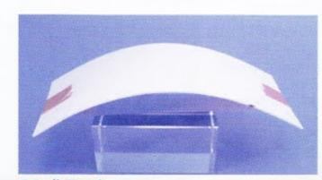
**32: 曲面の台** ガムテープの長さを調整することで、プラ板の曲率を変えるこ
