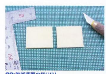
23: 胸部背面の切り出し 背中の面を切り出してみます。2ミリ厚で作ったレジン板を使用し、必要な上下幅より長めに切り出して、ほぼ中央でT字 定規で直角にカットします。
