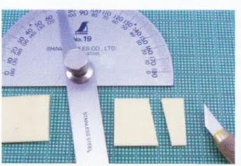
24: プロトラクターで片側をカット プロトラクター(分度器に回転する定規の付いた工具)を使って、背面の半分のサイズで必要な角度に端を切り落とします。
