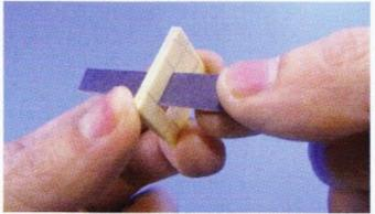
29: 左右の板を点付けしてヤスリがけ 穴の位置を揃えるため、左右の板を瞬着の点付けで仮止め してプラ板ヤスリで切断面を仕上げました。
